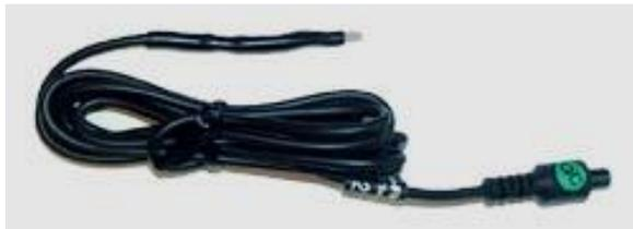
Der Temperatur-Sensor verfügt über ein Thermoelement (Thermistor), das die Temperatur des Gewebes (der Haut) an der Stelle, an der es appliziert wird, registriert. Die Temperatur ändert sich in Abhängigkeit davon, wie viel Blut durch das Gewebe fließt. Die Arteriolen, die das Gewebe durchziehen, sind umgeben von Fasern der glatten Muskulatur, die vom sympathischen Nervensystem
