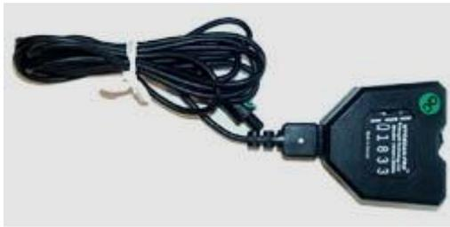
Die EMG-Aktivität repräsentiert die Summenpotentiale aller unter dem Ableitungsgebiet der Elektroden aktiven motorischen Einheiten. Das EMG ist ein sehr schwaches Signal (die Messwerte liegen im Mikrovolt-Bereich). Daher sind Verstärker mit hoher Leistung erforderlich. Beim MyoScan-Pro™ ist ein solcher Verstärker bereits in den Kopf des Sensors eingebaut.
